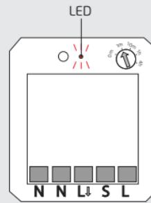
ACM-2300-HC UGRADNI PREKIDAČ
