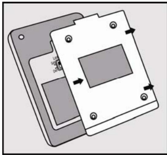
**[2]** Odvrnite sva 4 šrafa i otvorite kućište senzora.
