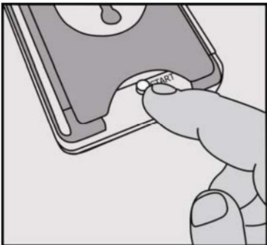
[8] Podesite nivo osvetljenja KucaNaKlik predajnika. Pritisnite 'Start' i držite : (A) 1 sekund - fabričko setovanje; (B) 3 sekunde - za podešavanje nivoa na vrednost trenutnog osvetljenja u prostoriji gde je senzor instaliran.
