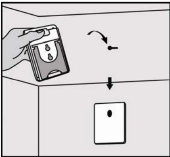
**[9B]** Iskoristite otvore sa zadnje strane senzora za montažu na zid.
