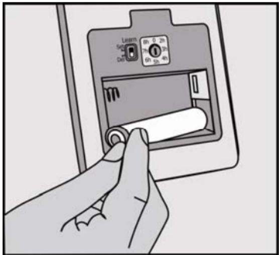
[3] Instalirajte 2 AAA alkalne baterije. Obratite pažnju na polaritet baterije prilikom instalacije.
