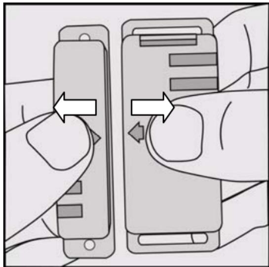
[3] Aktivirajte automatsku pretragu signala KucaNaKlik [4] Postavite oba dela senzora, jedan naspram drugog, prijemnika pritiskom na taster .
